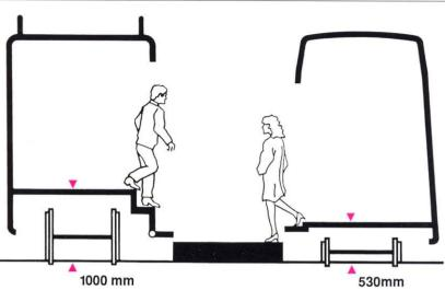
Hauteur du plancher  $\sim 1000~\text{mm}$ Gebräuchliche Bodenhöhe  $\sim 1000~\text{mm}$ Altezza normale del pavimento  $\sim 1000~\text{mm}$ Autezza normala dal palantschieu  $\sim 1000~\text{mm}$
