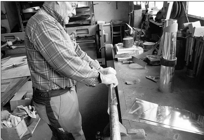
Marcel Bass storscha il sturs l'emprim cun maschina. Ma per propi cuntanscher la dretga furma sto el suentar anc volver e far radund a maun.
