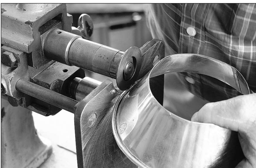
La maschina serra il fildarom en l'ur.
