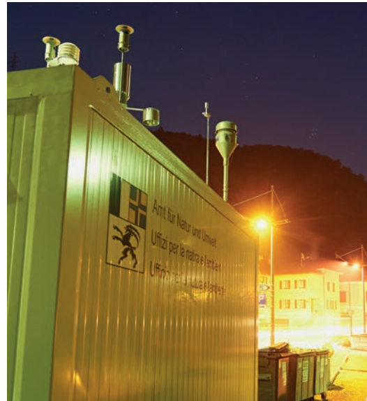
Das ANU misst an repräsentativen Standorten die Luftbelastung im Kanton Graubünden. Foto: Messstation San Vittore.
