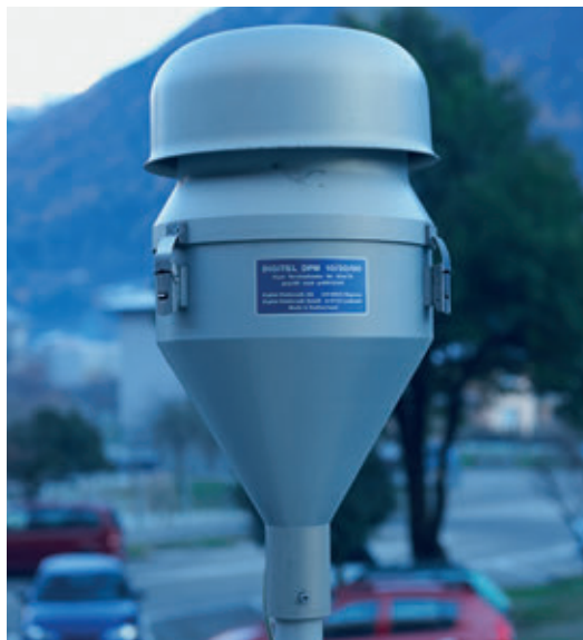
L'UNA, in diverse ubicazioni rappresentative sta misurando l'inquinamento dell'aria. Foto: stazione di misurazione delle polveri fini a San Vittore.
