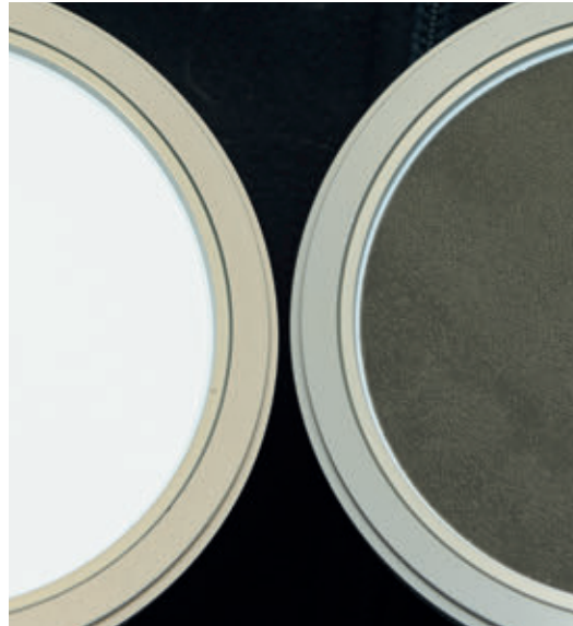
Das ANU misst an repräsentativen Standorten die Luftbelastung im Kanton Graubünden. Foto: Feinstaub (PM10)-Filter vor und nach der Probenahme.
