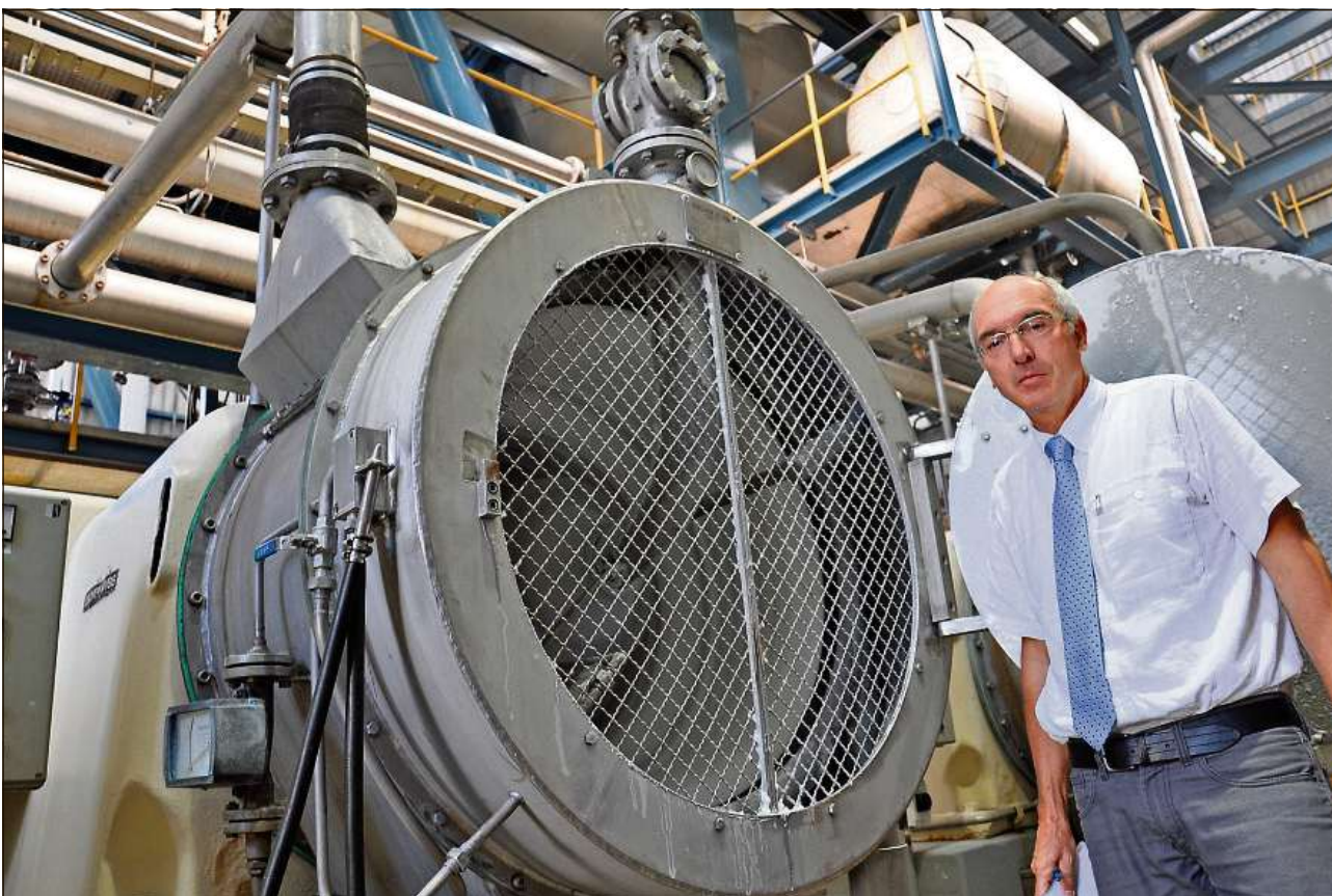
La zentrifuga schigenta la broda da sal. L'inschigner agronom Carl Habich è losch da la maschina che lavura dapi 45 onns senza incaps.
