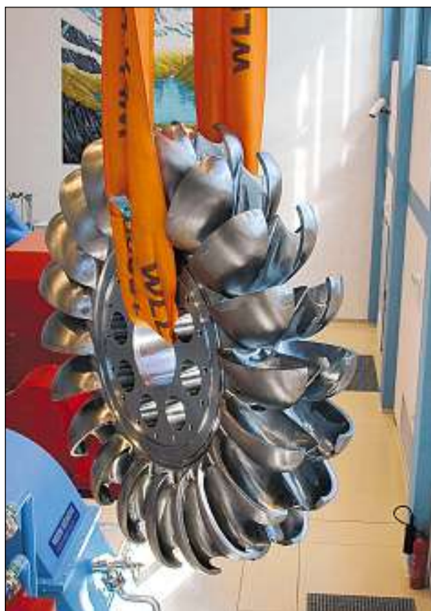
Ina nova turbina dal tip Pelton vegn installada.
