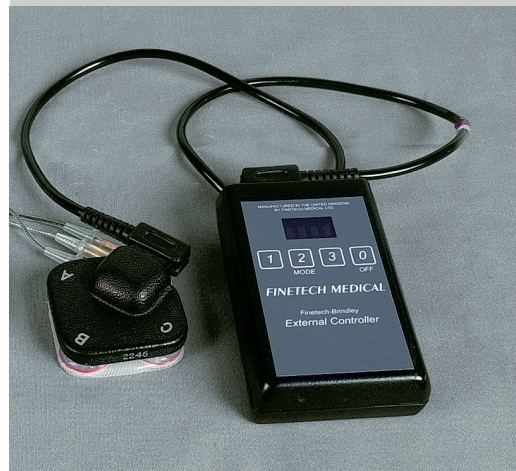
Alternativa en cas da basegn: Nua che mesiras conservativas na mainan betg ad ina meglieraziun da la funcziun da la vaschia, po in stimulator esser in agid efficaci. L'implantat (sura) consista d'electrodas (a dretga) che vegnan implantadas en la «gnerva da la vaschia», da cabels da colliaziun e d'in receptor. Ils pazients pon sponder aua cun agid d'in apparat da cumond (sut). L'antenna cun trais emetturs (a sanestra) vegn fixada sin la pel, directamain sur il receptor implantà.
